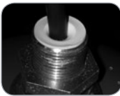
Positionnement incorrect de la membrane
