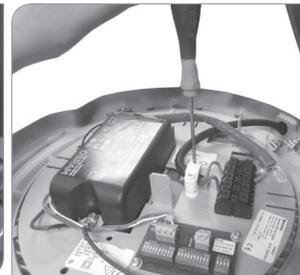
3.2 - Dévisser les vis Torx M5 en utilisant une clé T25 (4 vis au total)
