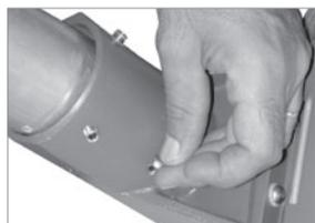
2.4 - Laisser 200 mm de câble dans le luminaire. Dégainer le câble sur 30 mm et dénuder les fils sur 8 mm. Serrer le presse-étoupe. (clé hexagonale de 26 mm)
