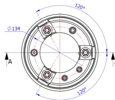
NB : La fixation de la borne peut être réalisée par scellements chimiques M12 (non fournis)
