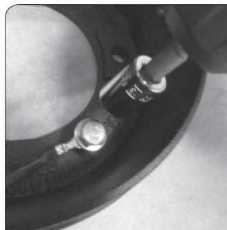
b) retirer la platine (3 vis H M5x12 + rondelles)
