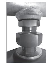
Dévisser complètement l'écrou du raccord oscillant.
