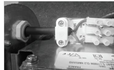
2.3 - Serrer le presse-étoupe à l'aide d'une clé plate de 24 mm.
