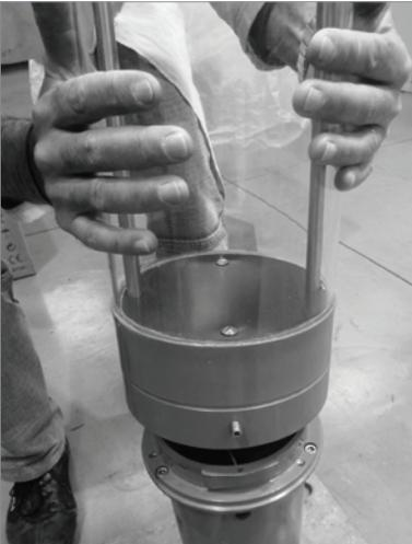
1.3 - En remontant le tube transparent veillez à laisser en place le joint d'étanchéité sur le pot
