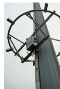
Sécurité anti-chute assurée par un frein parachute à came
